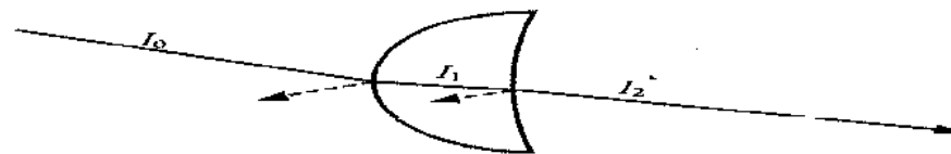
Figura 1: Riflessione (linea tratteggiata) e rifrazione (linea solida) di un singolo raggio di luce attraverso una lente trasparente.
